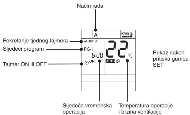
\* Usmjerite daljinski upravljač prema modulu primanja na klimatizacijskom uređaju pa pritisnite gumb dok se ne oglasii zvuk "Pipi", što znači da su postavke dovršene. Dok klimatizacijski uređaj prima signal, zvuk "Pi" oglasit će se jednak broj puta kao i broj dana su postavili.
